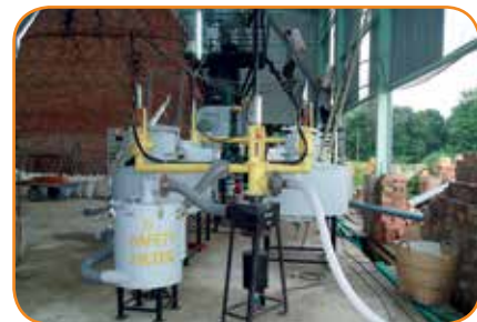
Dự án lò nung gạch gốm kết hợp hệ thống khí hóa từ trấu (Nguồn: ENERTEAM)
