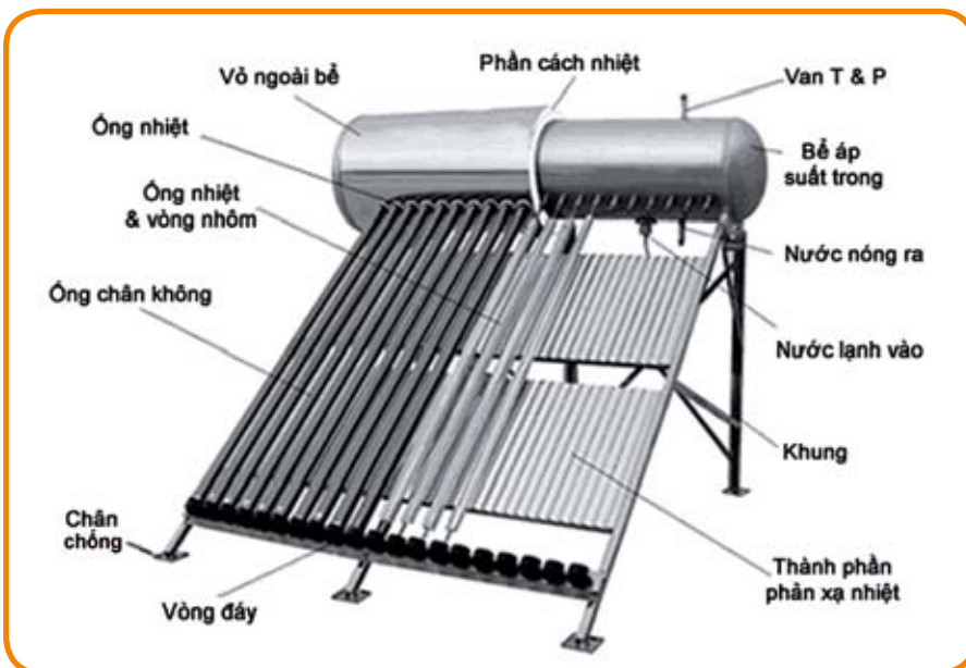
Các thành phần của bình nước nóng năng lượng mặt trời (Nguồn: Nhiên 2010)
